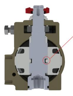
Pistone con chiavetta antiespulsione.
